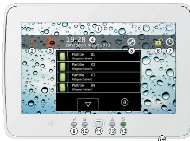
Afbeelding 1 De M-Touch toetsenpaneel is stand-by ( EN50131 uitgeschakeld).
